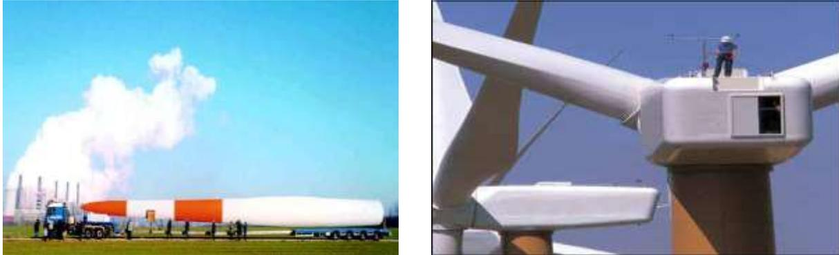
Fig. I.17 Pales de 39 m sur une NORDEX N80 (2.5MW).
