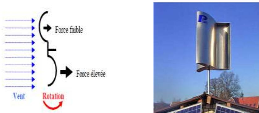
Fig. I.14 Effet du vent sur un corps creux (Le rotor de Savonius).
