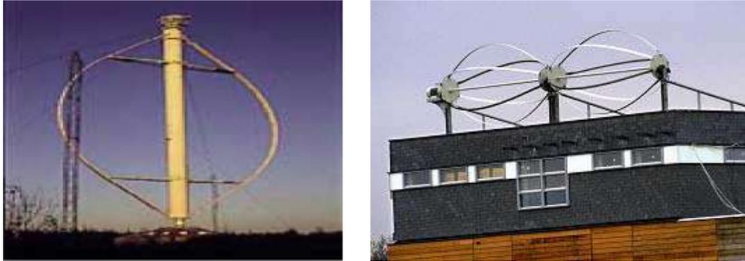
Fig. I.15 éolienne de Darrieus de 4.2MW et 100m de diamètre
