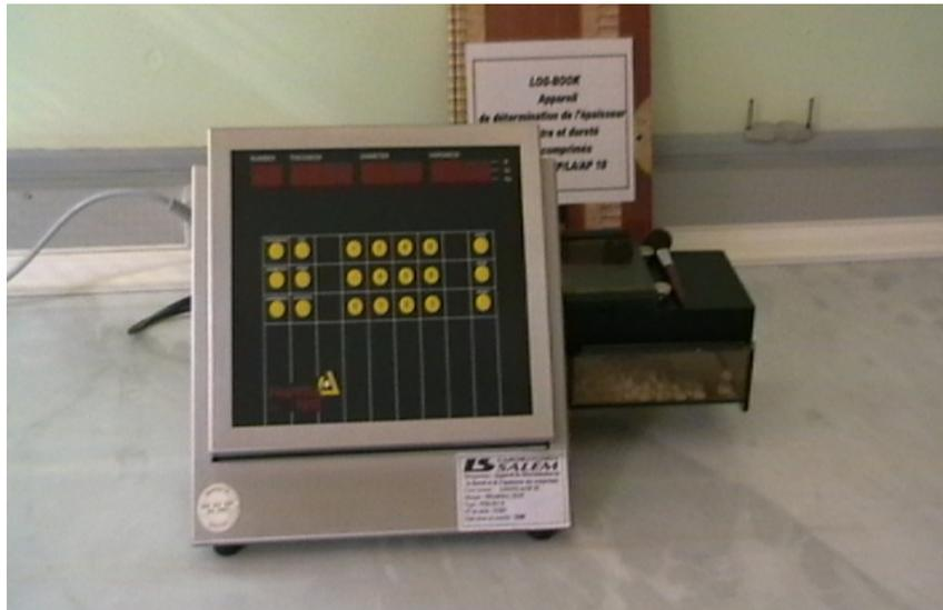
**Figure 17 :** Appareil de détermination de la dureté des comprimés.
