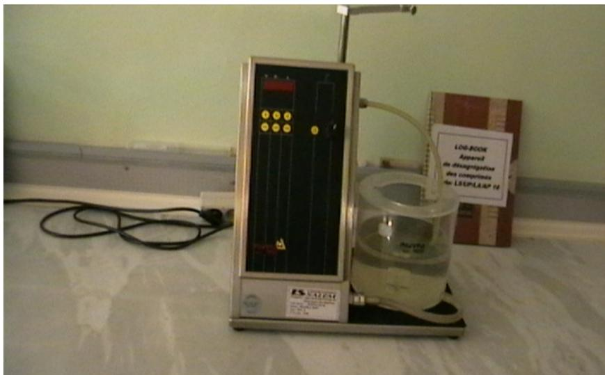
**Figure 18 :** Appareil de mesure du temps de désagrégation
