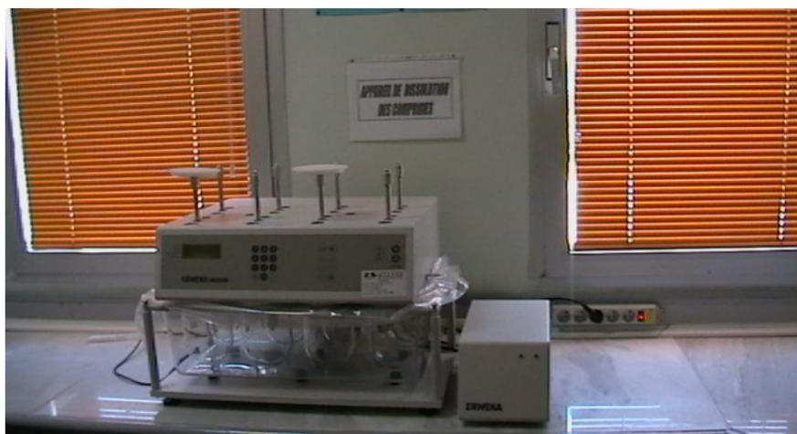
Figure 20 : Appareil de dissolution des comprimés (dissolutest)
