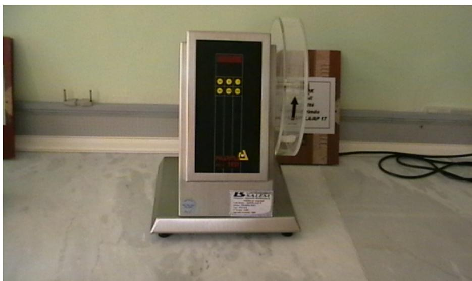
**Figure 19 :** Appareil de détermination de la friabilité des comprimés
