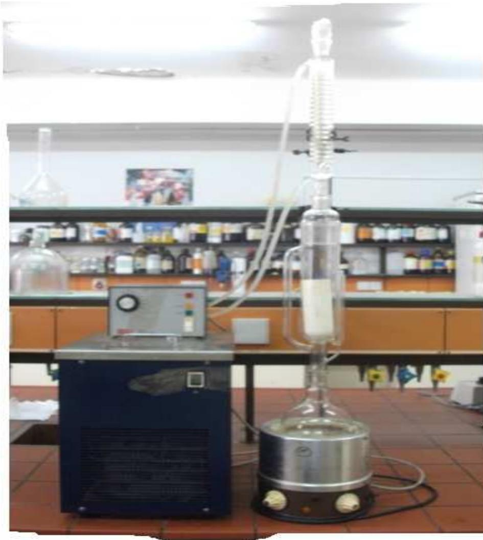
**Figure 14.** Appareil de soxhlet
