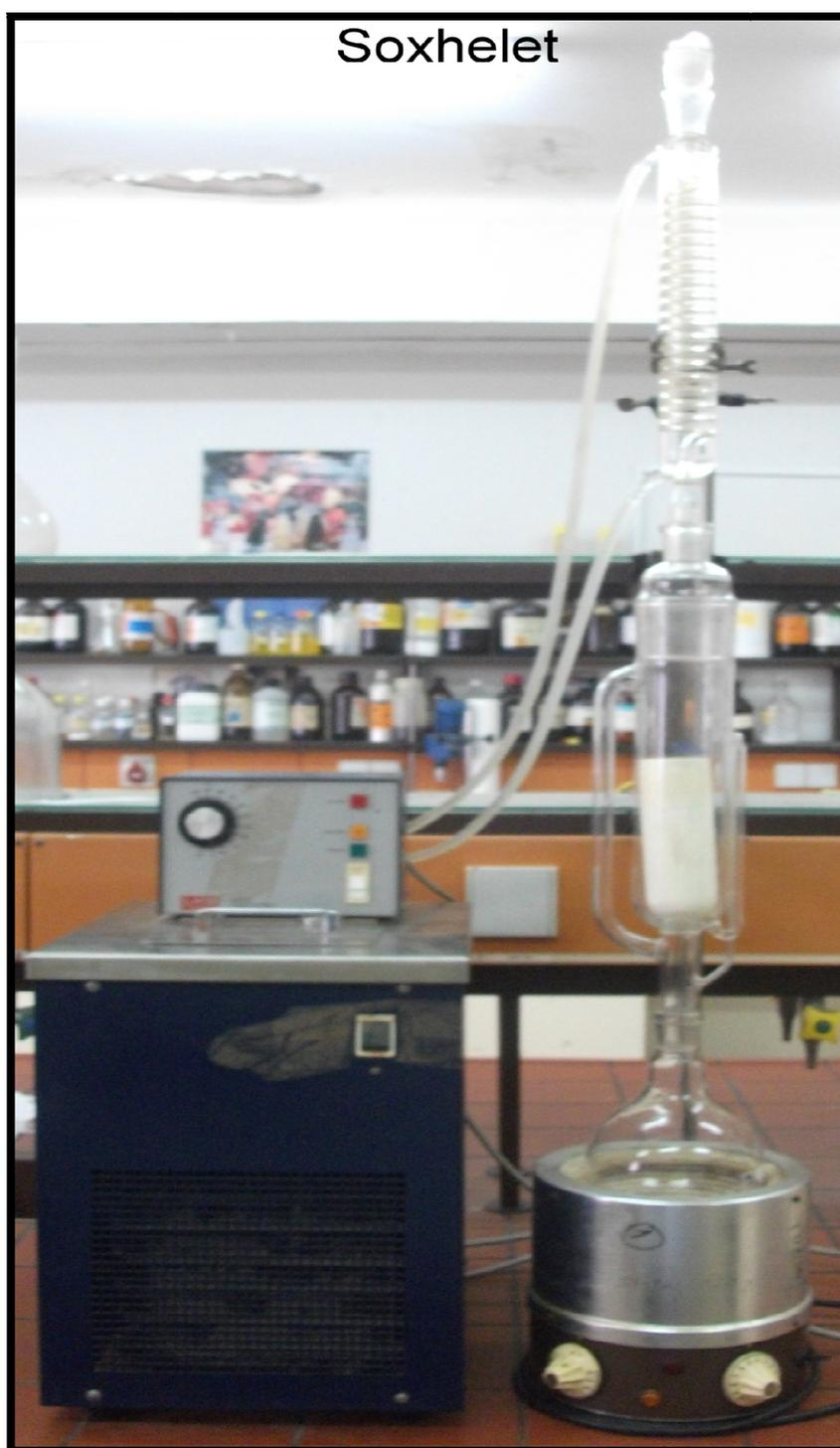
**Fig.13** : Extracteur de Soxhlet utilisé.
