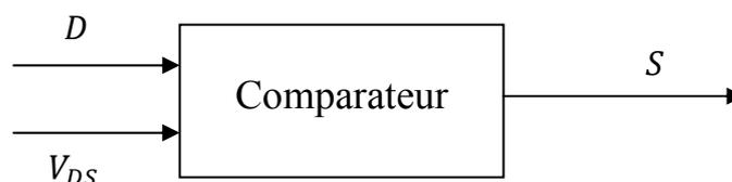
Figure II.10: Principe du PWM (DC/DC)
