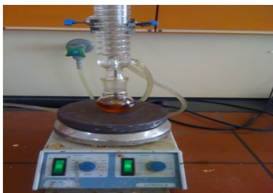
Fig. III.3 : Dispositif du montage de la synthèse au reflux du complexe de Ni.
