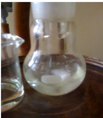
Fig. III.5 : Dispositif du montage de la synthèse du complexe de Cd au reflux.
