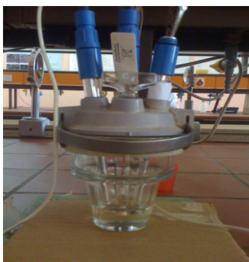
Fig. III.9 : cellule électrochimique.
