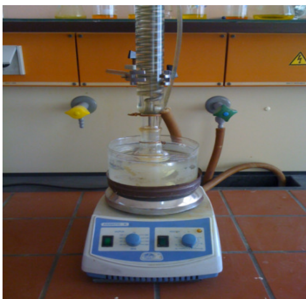
Fig. III.1 : Dispositif du montage de la synthèse du ligand au reflux.
