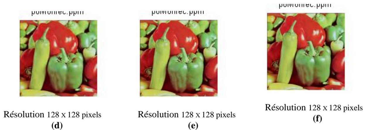
**Figure (IV-56) : Image ‘ poivron ’reconstruite divisée horizontalement et verticalement par 4 par rapport à l’image d’origine et à différents niveaux de qualité : (d) 0.1 bpp, (e) 0.2 bpp et (f) 0.5 bpp par le codeur JPEG2000.**
