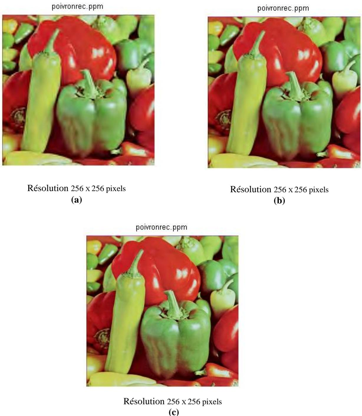
**Figure (IV-55) : Image ‘ poivron ’reconstruite divisée horizontalement et verticalement par 2 par rapport à l’image d’origine et à différents niveaux de qualité : (a) 0.1 bpp, (b) 0.2 bpp et (c) 0.5 bpp par le codeur JPEG2000.**
