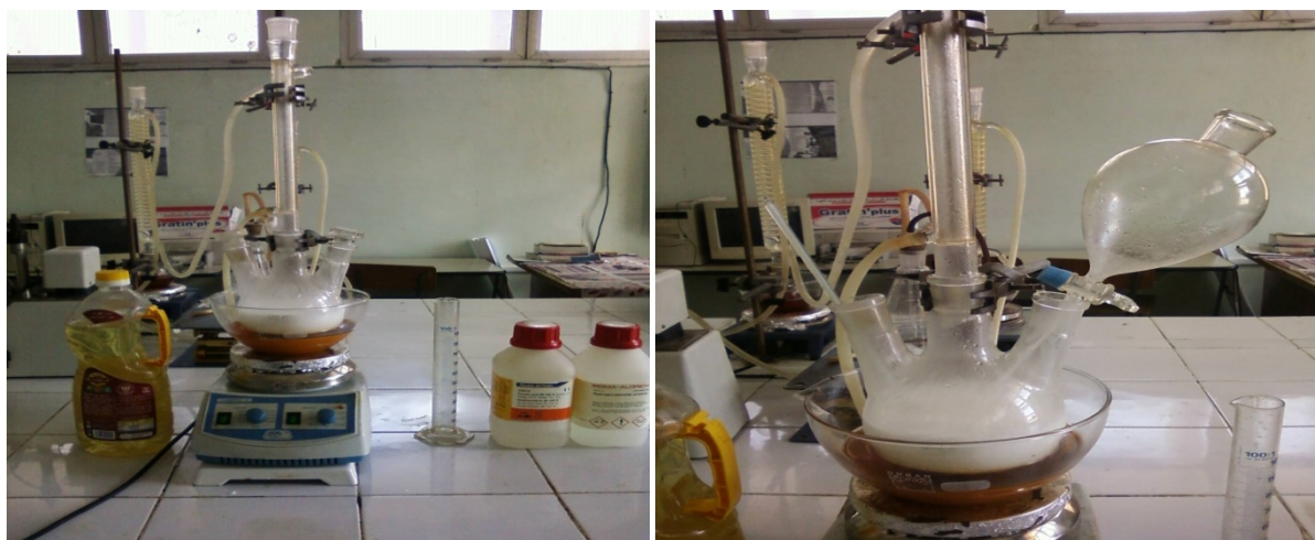
Figure III-1. Montage expérimental de l'époxydation de l'huile de tournesol commerciale.
