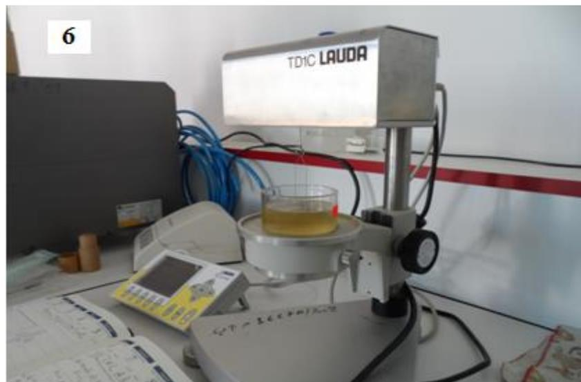
Figure 5 et 6. Tentiomètre (DU NOUI RING METHOD) TD1C LAUDA.
