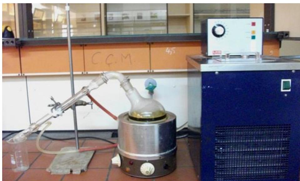
Figure 8 : Le système d'hydrodistillation
