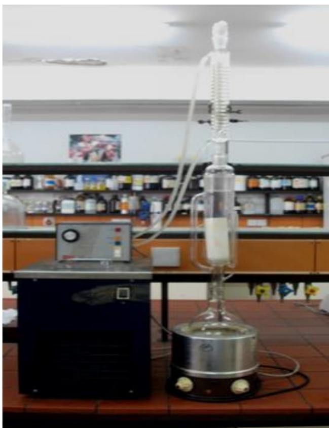
Figure 7 : Extraction des huiles fixes par Soxhlet
