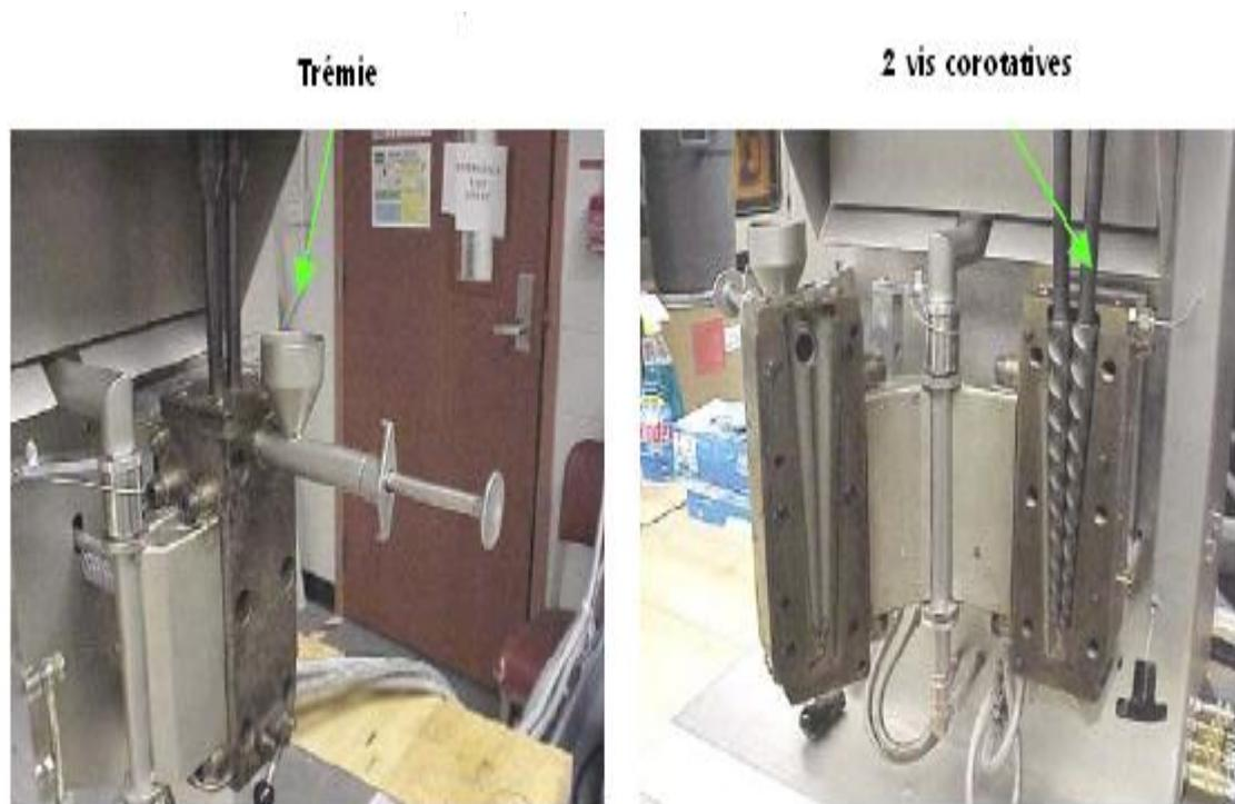
Figure II.1. Photos de la micro-extrudeuse DSM 15.
