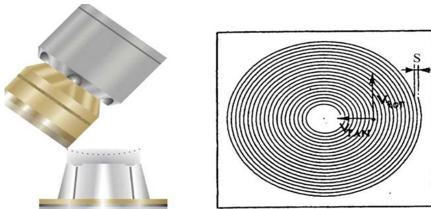
Fig.3.15: Principe de meulage (ACG)
