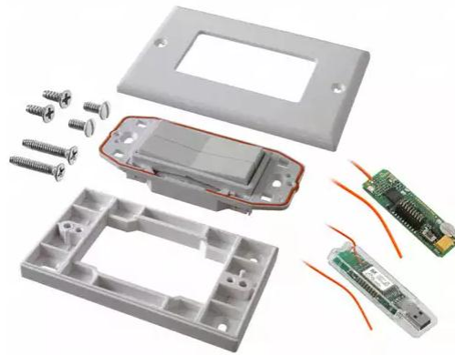
Figure II. 1: Système sans fil basé sur la récupération d'énergie (autoalimenté), Dolphin d'EnOcean . Source : Rédacteurs européens de Digi-Key, 2014 .
