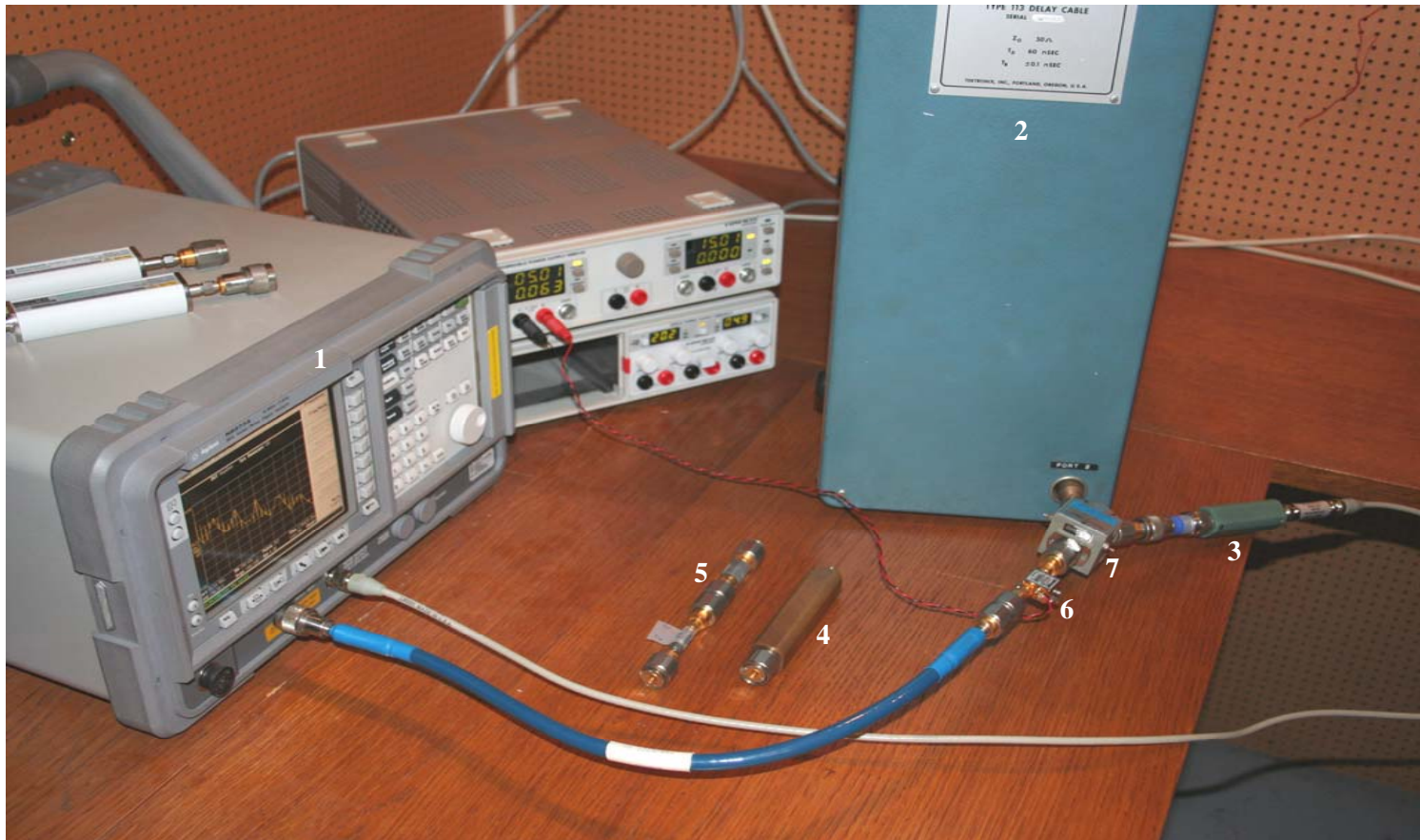
(1) NFA (2) Ligne longue (3) Source de bruit adaptée (4) Source de bruit désadaptée (5) DUT (6) Amplificateur Mini-Circuit (7) Relais
