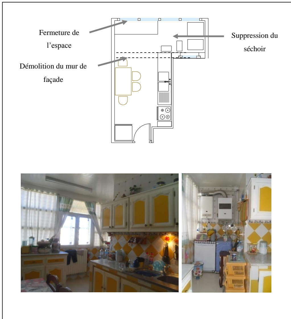
Figure 45 : Agrandissement de la cuisine à travers l'incorporation du séchoir
