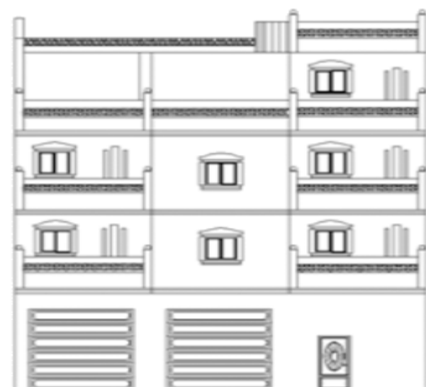
Façade (B) de logement évolutif dont la nouvelle extension se caractérise avec des portes au RDC et la porte d'entrée excentrée vers la partie droite
