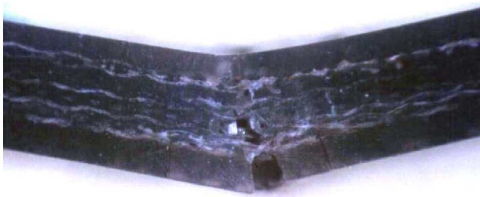
Fig. 4.47. Faciès de rupture après endommagement du stratifié [+60_2/-60_2/90_4]_s
