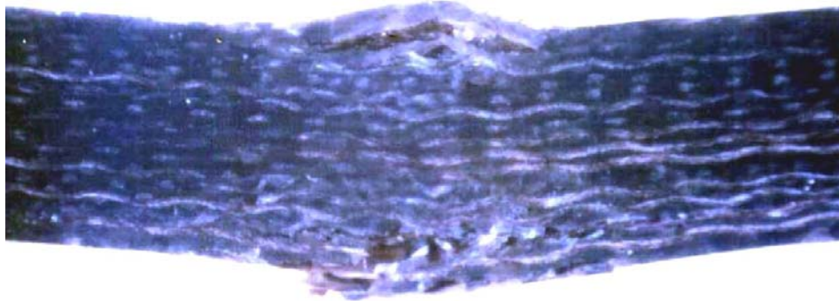
Fig. 4.44. Faciès de rupture après endommagement du stratifié [(0_2/90_2)_s]_s
