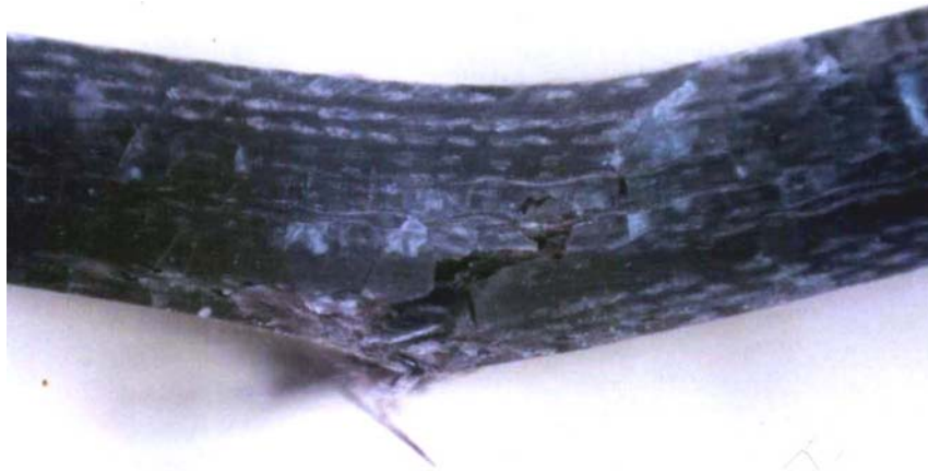
Fig. 4.46. Faciès de rupture après endommagement du stratifié [+45_2/-45_2/90_4]_s
