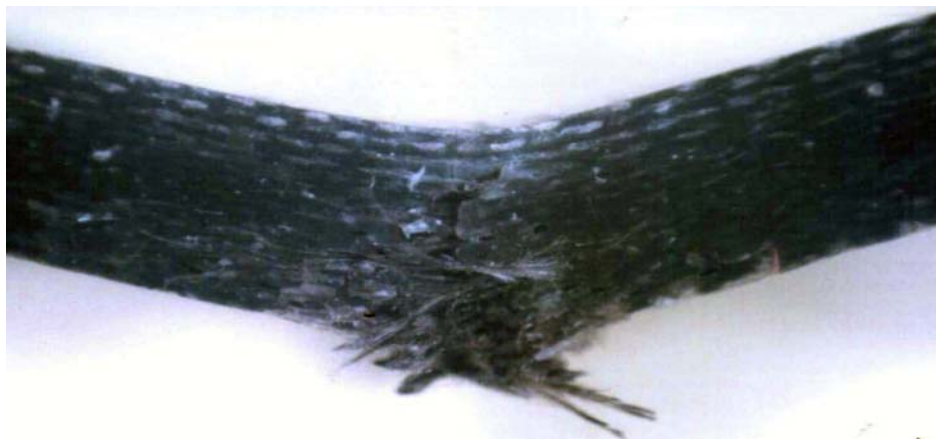
Fig. 4.45. Faciès de rupture après endommagement du stratifié [+30_2/-30_2/90_4]_s
