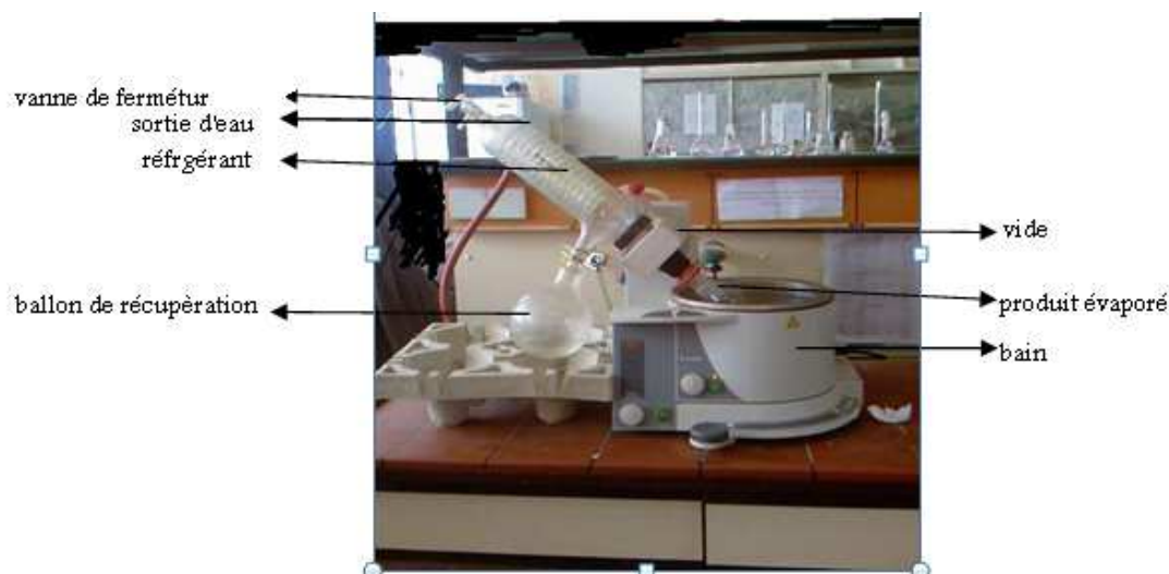
Figure III-2 : Montage expérimental utilisé pour l'évaporation des solvants du milieu réactionnel
