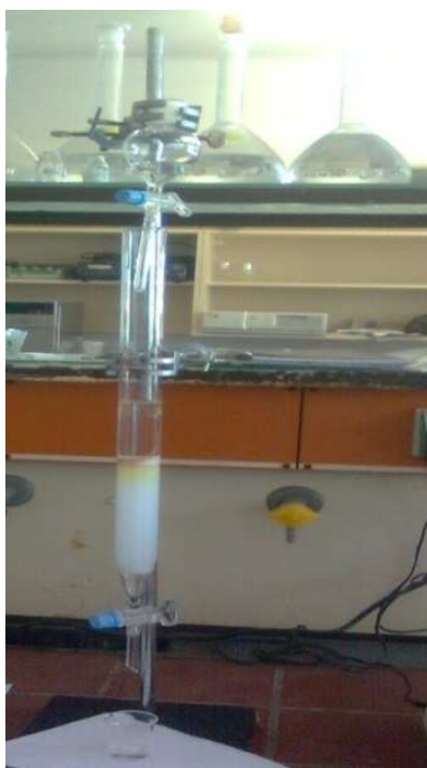
Figure III.3 : Image de séparation et purification des produits synthétisés sur colonne chromatographique.
