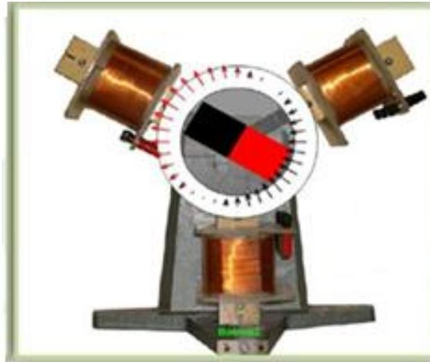
**Fig. (I-1) :** Schéma d'une machine synchrone à aimant permanent.
