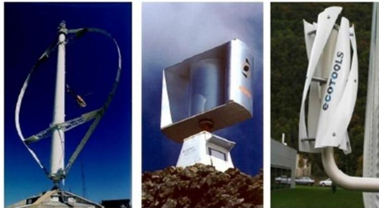
Fig. (I. 10) : éoliennes à axe verticale, [6].
