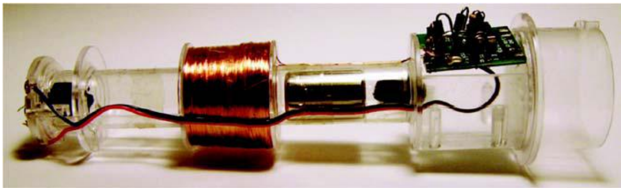
Figure I.6 : Lampe torche utilisant un générateur électromagnétique
