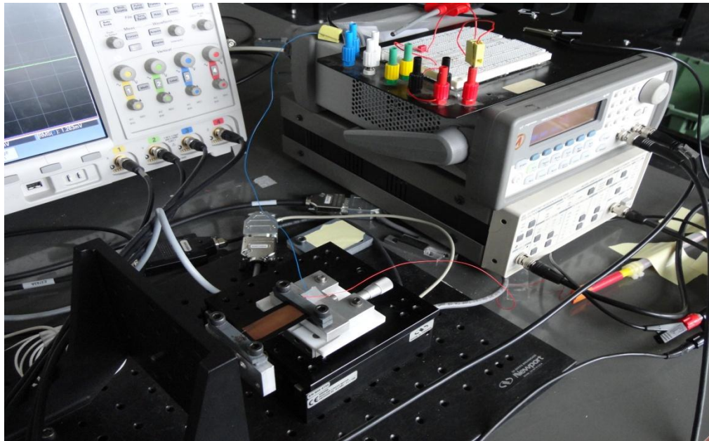
Figure IV.13 : Photographie de l'installation expérimentale pour mesurer le courant récupéré par polymères électrostrictives.
