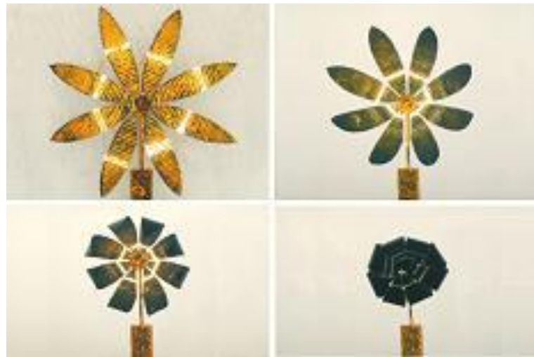
Figure 11.3 : "Fleur" micro-origami à base de polymère conducteur par Smela et al. [36], [37].
