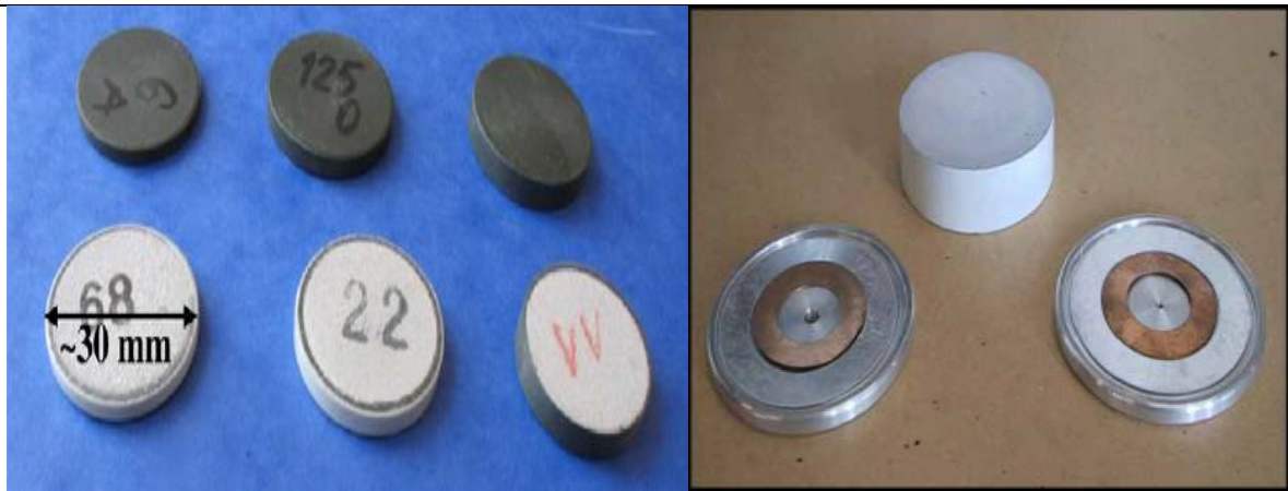
Fig. 1.2. disques de varistances à diamètre différent
