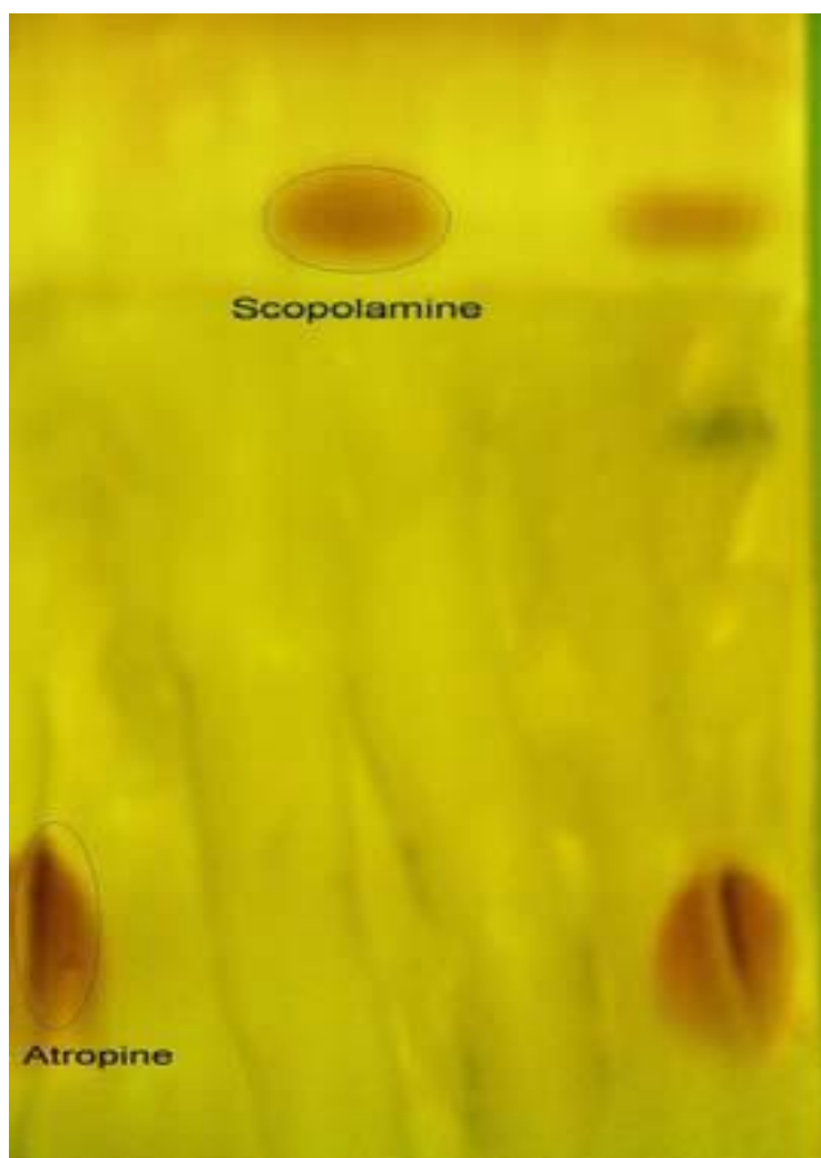
Figure 15 : Séparation par chromatographie sur couche mince des alcaloïdes tropaniques majoritaires (atropine et scopolamine) des graines de Datura stramonium L. Phase mobile : méthanol/chloroforme/ammoniaque: 78.5/20/1.5 (V/V/V). Révélateur : réactif de Dragendorff.
