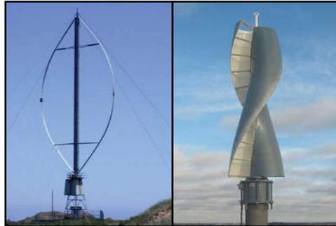
**Figure 1.10.** Les éoliennes à axe vertical
