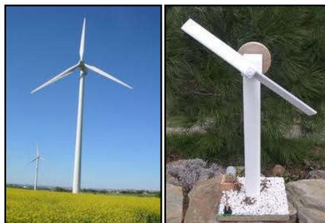
**Figure 1.9.** Les éoliennes à axe horizontal : tripale\_bipale
