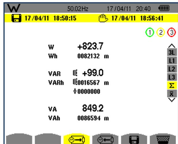
Figure III.62. Bilan des puissances après la mise en service du FAPP.
