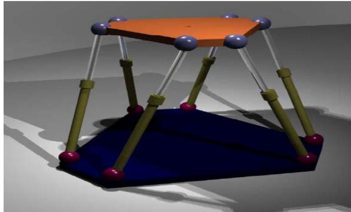
Figure 1.1: Hexapode ou plate-forme de Gough-Stewart.
