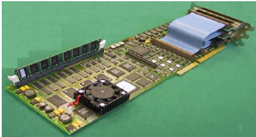
Figure 1.14: Carte dSPACE DS 1103 utilisée pour la commande de systèmes robotiques considérés.
