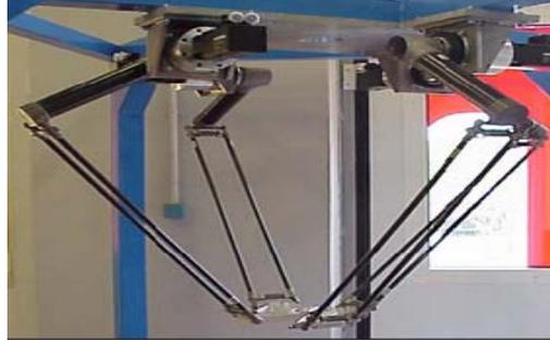
Figure 1.6: Robot parallèle I4R
