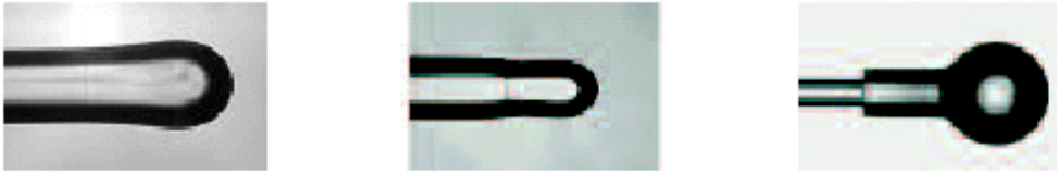
Fig.37. Vue de trois micros collimateurs typiques (a), (b) et (c) représente trois microlentilles de différents rayons de courbure [44]
