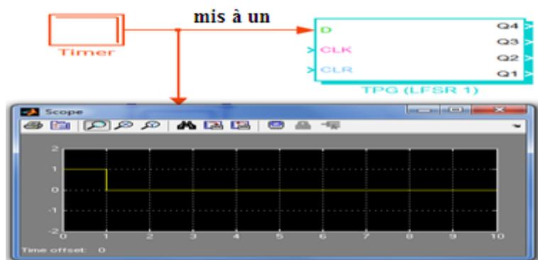
**Figure 4 .37 : Mise à un de la bascule D**
