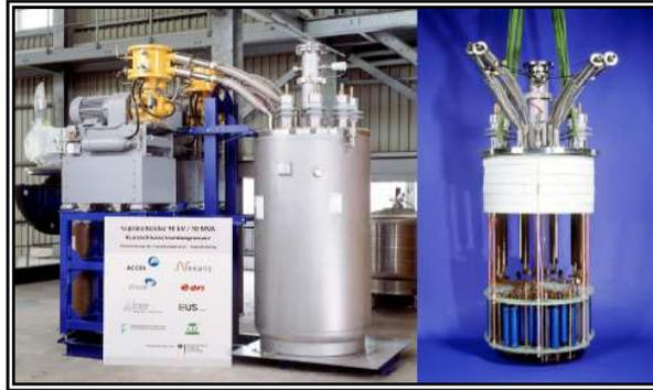
**Figure IV.11.** Schéma réel d'un limiteur de courant supraconducteur
