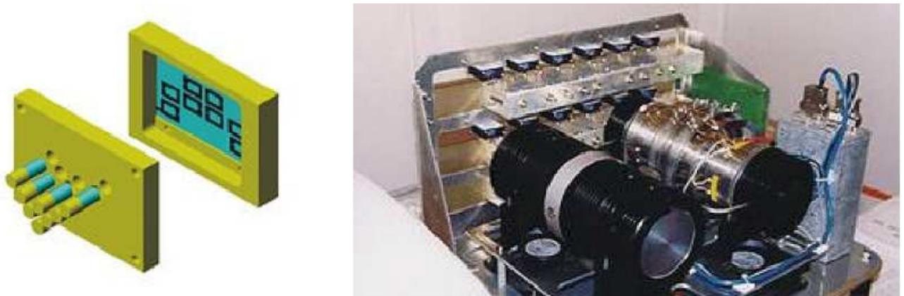
**Figure I.21.** Boîtier contenant 8 filtres YbaCuO, et intégration dans un châssis intégrant le cryogénérateur 30 K.
