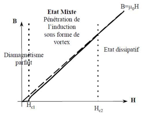
Figure I.11. Induction magnétique dans les supraconducteurs de type II.
