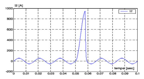
Figure V. 5. Allure du courant de défaut sans SFCL
