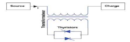
Figure III.3. Limitation de courant par transformateur court-circuité
