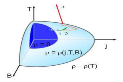
Figure IV.2. Diagramme de phase simplifié de l'état supraconducteur
