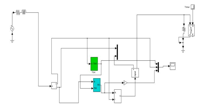
Figure V. 7. Circuit de simulation du SFCL monophasé
