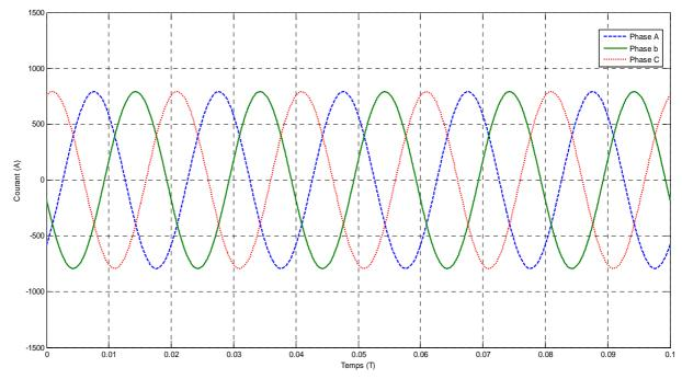
Figure V. 14. Allure du courant dans les trois phases sans SFCL
