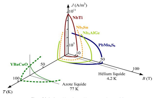
Figure I.2. Surface critique des matériaux supraconducteurs. [6]
