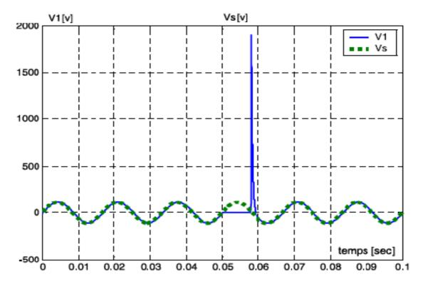
Figure V. 6. Allure de la tension aux bornes de la charge et de l'alimentation sans SFCL
