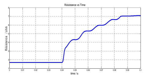
**Figure V.36.** Variation de la résistance en fonction du temps avant et après le défaut dans le deuxième modèle thermique
