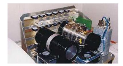
**Figure I.21.** Boîtier contenant 8 filtres YbaCuO, et intégration dans un châssis intégrant le cryogénerateur 30 K.
