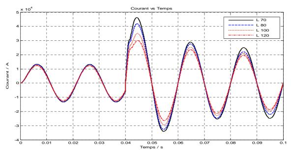
**Figure V.30.** Le courant de défaut correspond aux différentes longueurs du SFCL à une épaisseur de 0.009m (k=0.7)
