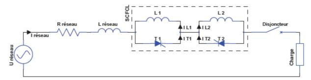
Figure III.9. Principe du limiteur de courant de type contrôleur de courant de défaut.
