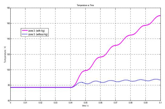
Figure V. 38. Variation de la température en fonction du temps dans la Zone-3, avec et sans le shunt (Ag)
