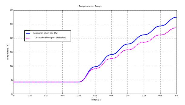
**Figure V. 39.** Comparaison de la variation de la température en fonction du temps, entre deux matériaux le (Ag) et (Hastelloy), dans la construction de couche shunt
