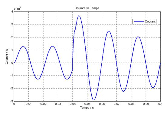
Figure V.20. Allure du courant en fonction du temps pendant le défaut
