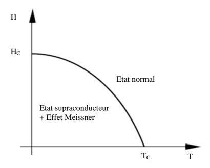
Figure I.5. Diagramme de phases d'un supraconducteur de type I [9].
