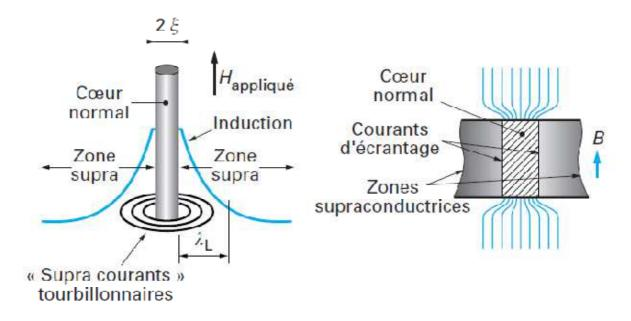
Figure I.14. Structure d'un vortex isolé
