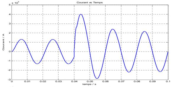
Figure V.35. Allure de courant en fonction du temps pendent le défaut dans le deuxième modèle thermique
