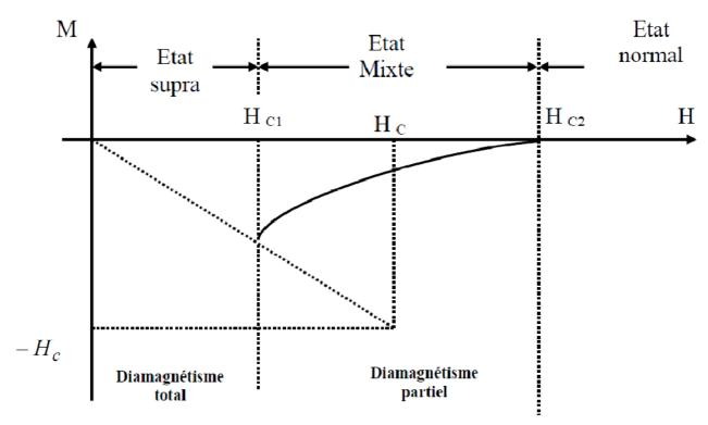
Figure I.9. Courbe d'aimantation d'un supraconducteur de type II
