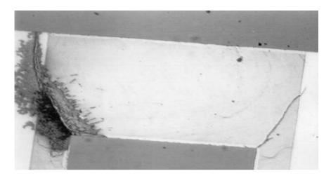
**Figure V.1.** Dégradation des matériaux due à un échauffement thermique lors d'un test (Université de Genève).
