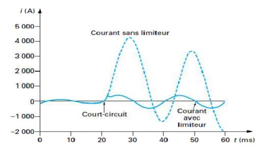
Figure III.5. Courants de court circuit avec et sans limiteur
