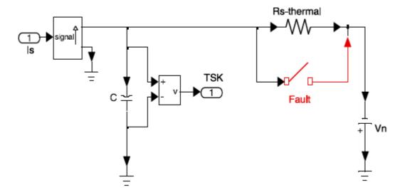
Figure IV.7. Schéma de modélisation de la température réelle du matériau supraconducteur
