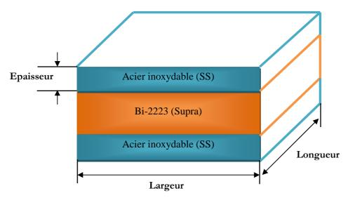
Figure V. 1 6. La conception du première modèle de simulation proposé
