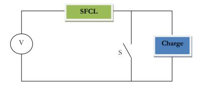
Figure V. 1 9. Circuit électrique dans le mode de fonctionnement en défaut
