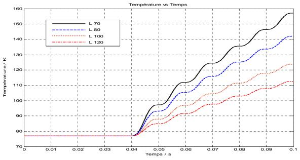
**Figure V.31.** La température en fonction de différentes longueurs du SFCL à une épaisseur de 0.009 m (k=0.7)
