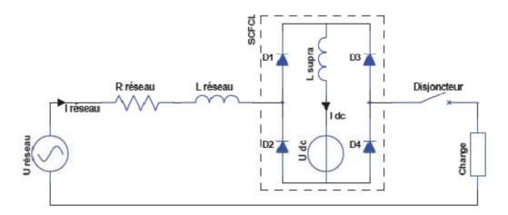
Figure III.8. Principe du limiteur de courant de type pont redresseur
