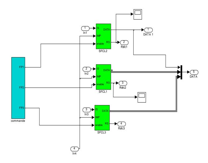
Figure V. 13. Vue interne du block de simulation d'un SFCL triphasé
