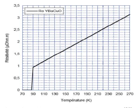
**Figure II.2.** Résistivité de l'YBaCuO en fonction de la température [28].
