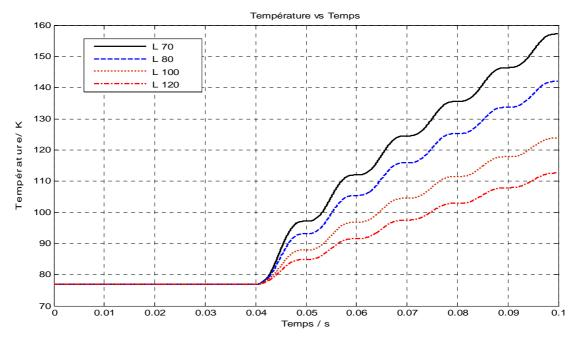
**Figure V.27.** La température en fonction de différentes longueurs du SFCL à une épaisseur de 0.009m (k=0.8)
