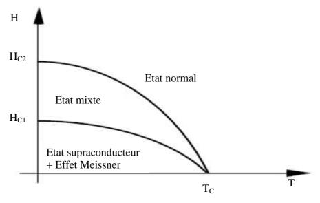
**Figure I.6.** Diagramme de phases d'un supraconducteur de type II [12].
