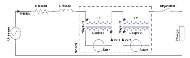
Figure III.10. Principe du limiteur de courant du type noyaux magnétiques saturés.
