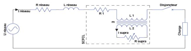
Figure III.7. Principe du limiteur de courant inductif
