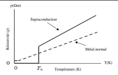
Figure I.1. Allure des résistivités d'un supraconducteur et d'un métal normal en fonction de la température
