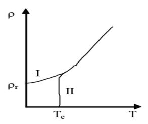
**Figure I.3.** Dépendance de la résistivité en fonction de la température pour l'état normal (I) et l'état supraconducteur (II)
