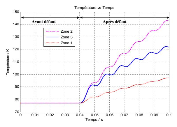
Figure V.23. Variation de la température en fonction du temps avant et après le défaut
