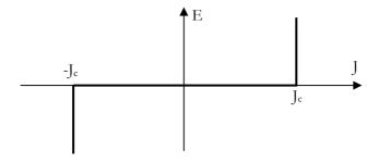
Figure I.20. Caractéristique E(j) d'un supraconducteur, modèle de l'état critique.
