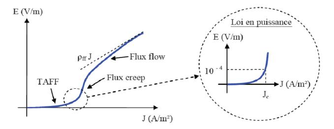
Figure I.15. Caractéristique E(J) d'un supraconducteur avec activation thermique
