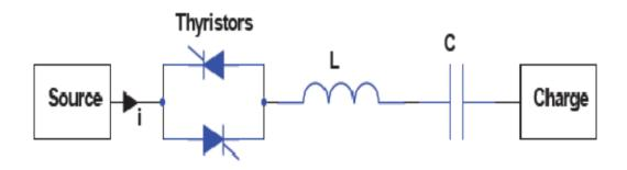
Figure III.4. Limitation de courant par thyristors contrôlant un circuit raisonnant [45].
