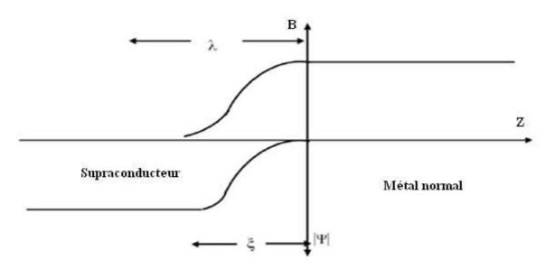
**Figure I.18.** Variation de B et  $|\Psi|$  a l'interface supraconducteur-normal pour un Supraconducteur de type II,  $(\xi < \lambda)$
