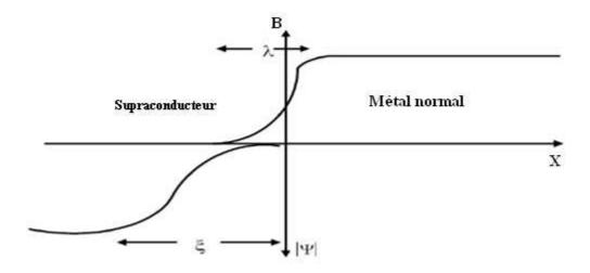
**Figure I.17.** Variation du champ magnétique et du  $|\Psi|$  à l'interface supraconducteur-normal pour un supraconducteur de type I,  $(\xi > \lambda)$
