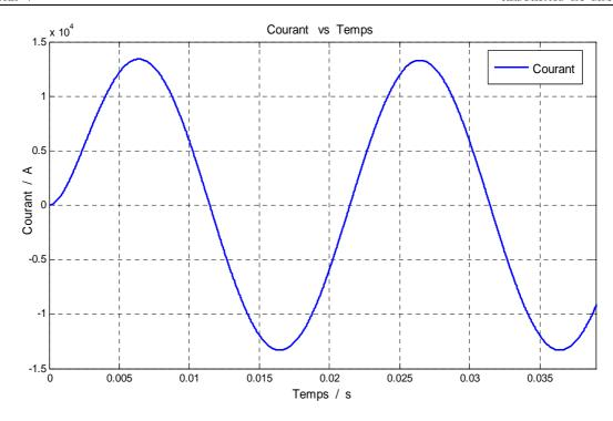
Figure V. 17. Allure de courant en fonction du temps pendent l'opération normale (sans défaut)
