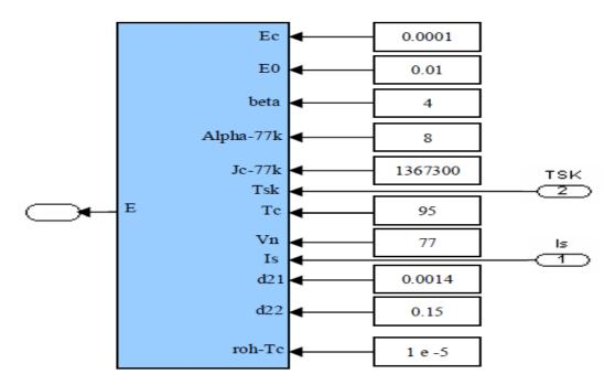
Figure IV. 5. Bloc de modélisation du champ électrique.
