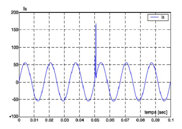
Figure V. 8. Allure du courant de défaut avec SFCL
