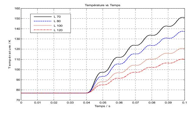
**Figure V.25.** La température en fonction de différentes  $\,$  longueurs du SFCL à une épaisseur  $\,$  de 0.002m (k=0.8)
