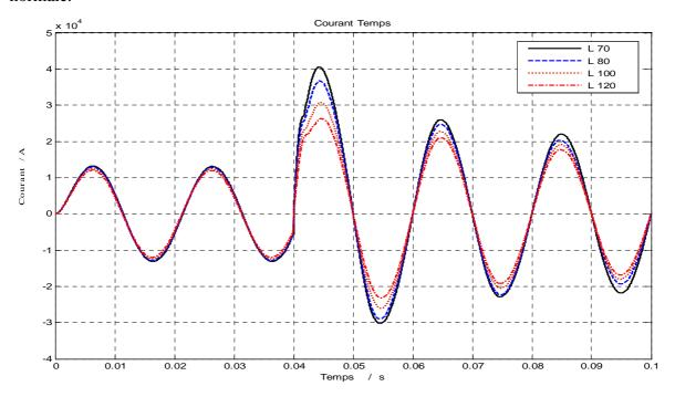
**Figure V.24.** Le courant de défaut correspond à différentes longueurs du SFCL à une épaisseur de 0.002m (k=0.8)
