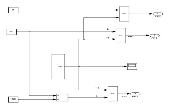
Figure V. 12. Circuit de commande des résistances supraconductrices dans un SFCL triphasé
