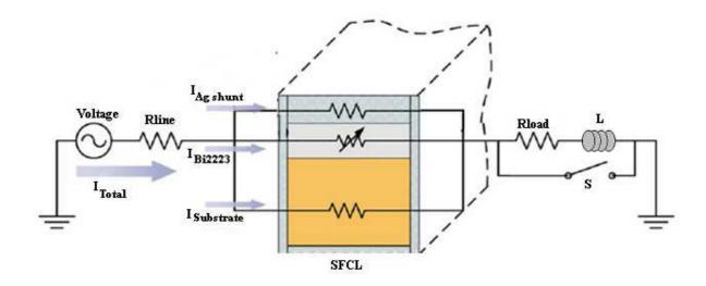
Figure IV.16. Circuit électrique du SFCL thermique
