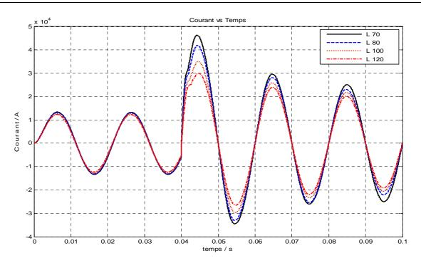
**Figure V.28.** Le courant de défaut correspond à différentes longueurs du SFCL à une épaisseur de 0.002m (k=0.7)
