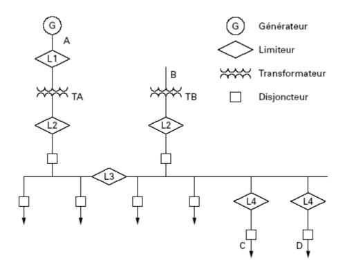
Figure III.11. Insertion de limiteurs de courant de défaut dans un réseau.
