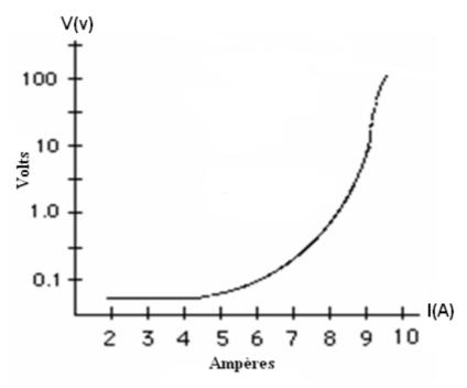
**Figure I.4.** La caractéristique tension courant pour un fil supraconducteur [7].
