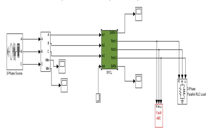
Figure V. 11. Circuit de simulation du SFCL triphasé
