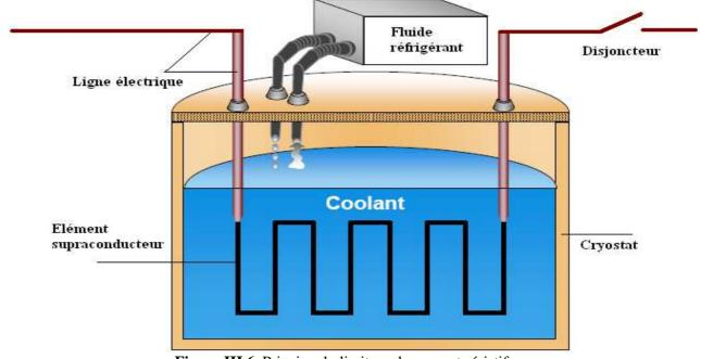
Figure III.6. Principe du limiteur de courant résistif
