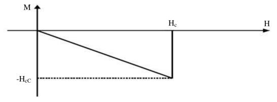
Figure I.8. Courbe d'aimantation d'un supraconducteur de type I
