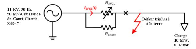
Figure V. 10. Circuit électrique du SFCL triphasé
