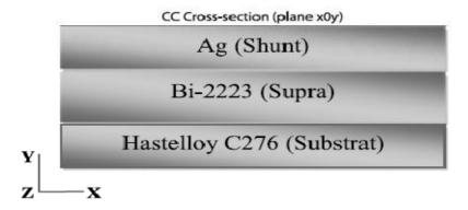
Figure V.34. La conception du deuxième modèle de simulation proposé
