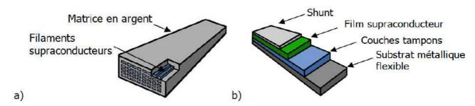
**Figure IV.9.** Schémas simplifies de conducteurs HTS : a) première génération, conducteur PIT; b) seconde génération, conducteur en couche mince
