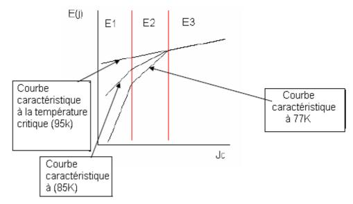
**Figure IV.6.** Caractéristique E(j) à différents températures
