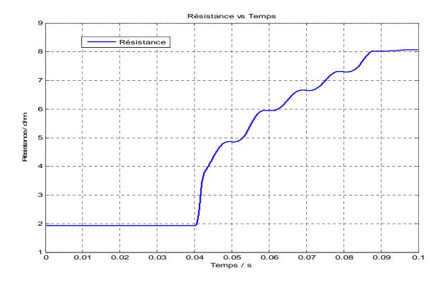
Figure V.21. Variation de la résistance en fonction du temps avant et après le défaut
