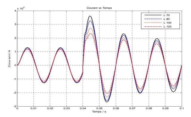
**Figure V.32.** Le courant de défaut correspond à différentes longueurs du SFCL à une épaisseur de 0.002m (k=0.9)
