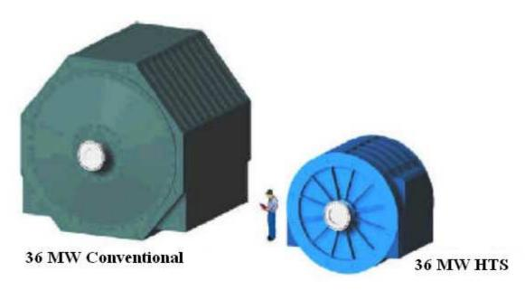
Figure I.22. Comparaison entre le moteur conventionnelle et le moteur supraconducteur
