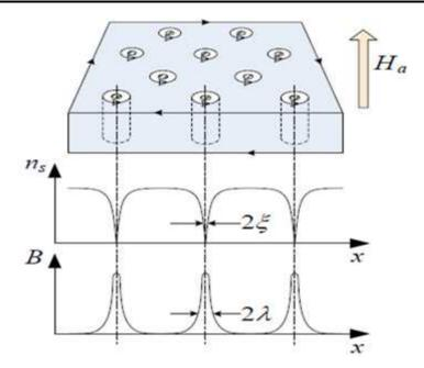
**Figure I.16.** Illustration du réseau de vortex, de la longueur de cohérence  $\xi$  et de l'épaisseur de pénétration de London  $\lambda$  pour un supraconducteur dans l'état mixte.
