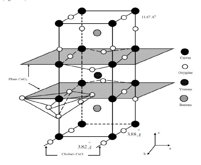
Figure II.1. Structure cristallographique de l'YBaCuO
