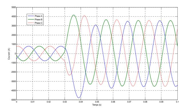
Figure V. 15. Allure du courant dans les trois phases avec SFCL
