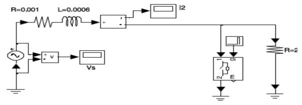
Figure V. 4. Circuit de simulation du défaut sans SFCL
