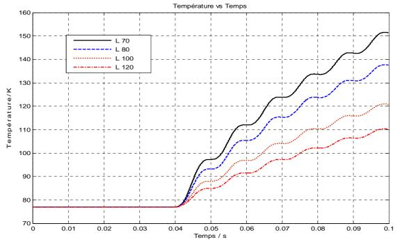
**Figure V.29.** La température en fonction de différentes longueurs du SFCL à une épaisseur de 0.002~m (k=0.7)
