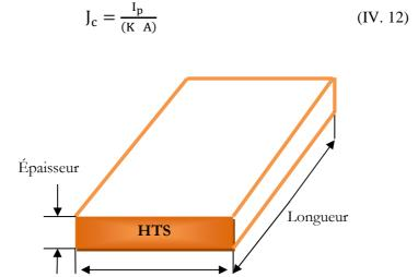
Figure IV.14. Schéma de la couche supraconductrice
