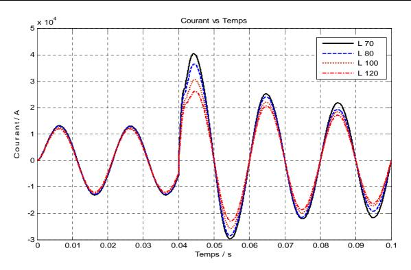
**Figure V.26.** Le courant de défaut correspond à différentes longueurs du SFCL à une épaisseur de 0.009m (k=0.8)
