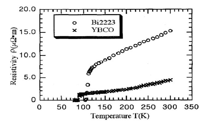
Figure IV.1. Variation de la résistivité avec la température de Bi-2223 et YBCO
