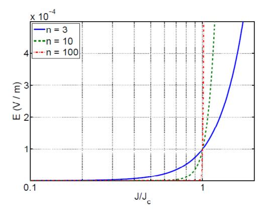
Figure I.19. Caractéristique E(j) d'un supraconducteur
