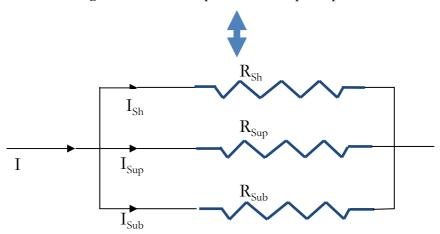
Figure IV.13. Schéma électrique équivalent d'un SFCL
