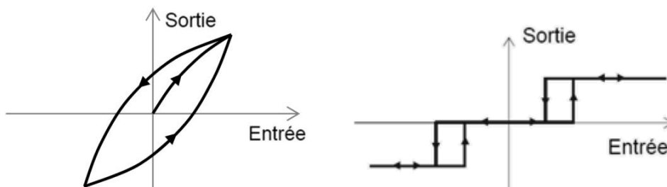
Fig. 1.2 Réponse d'un système à hystérésis : à gauche, hystérésis simple, à droite, hystérésis TOR avec seuil.
