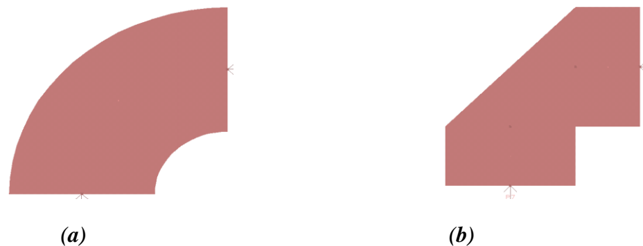
Figure IV.2 : Coudes en ligne microruban ; (a)-circulaire, (b)-chanfreiné
