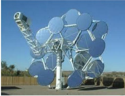
Figure 57 : Moteur Stirling couplé à des miroirs solaires.
