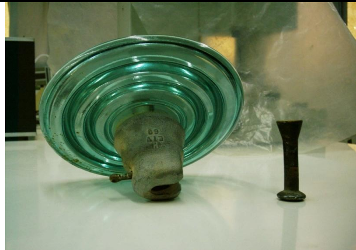
Fig. 3.1 Isolateur capot et tige étudié
