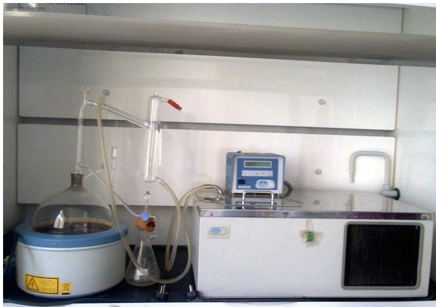
Figure 17: Appareil de distillation type Clevenger avec un Cryostat-réfrigérant
