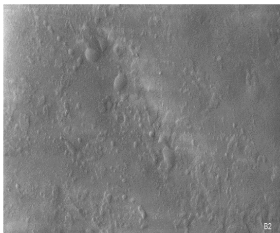
Figure IV.2. Microphotographies MEB des mélanges PEBD-L/TPS: a/ sans compatibilisant, et en présence de MA: b/2,5%, c/ 5% et d/ 7,5% [61]
