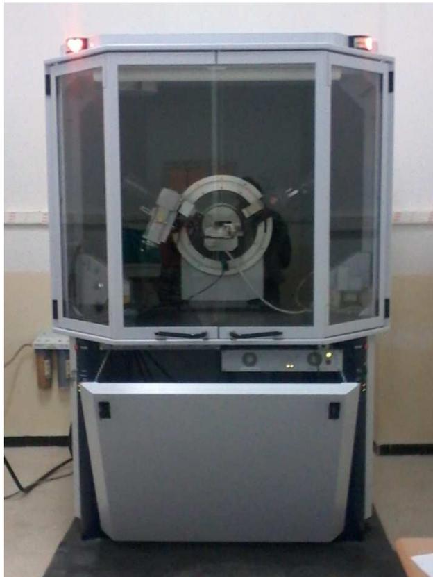
*Figure III-8: Photographie du diffractomètre aux rayons X de l'université de Sétif 1.*
