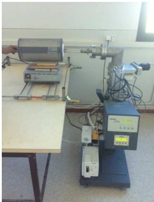
Figure II.5 : Photographie du Four à recuit sous vide.
