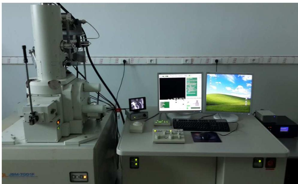
Figure III.11 : Photographie du Microscopie électronique à balayage.
