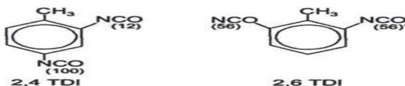
**Figure I.18.** Isomères du diisocyanate de toluène (TDI) et le taux de réaction relative des divers groupes isocyanate à température ambiante. [ETA03]
