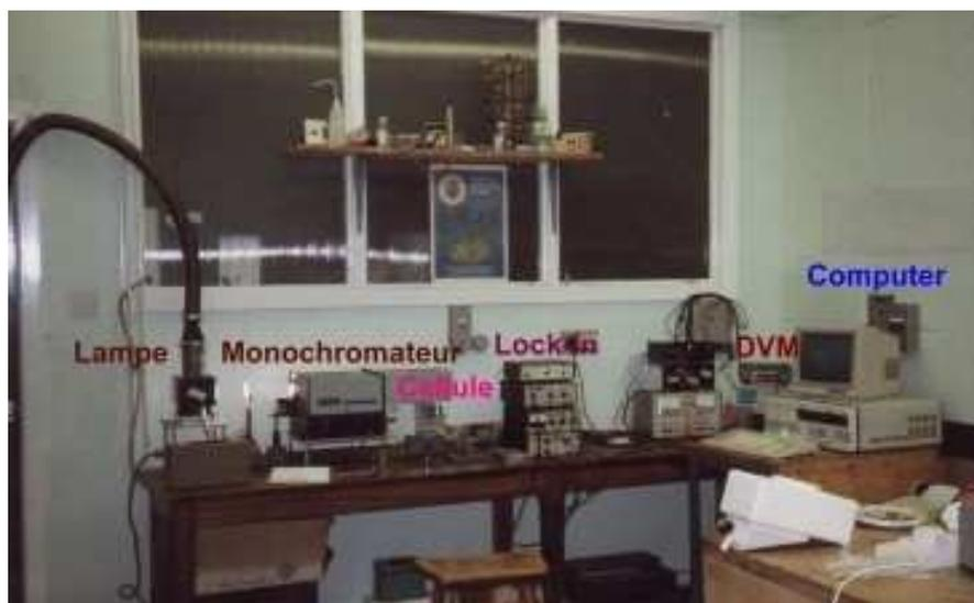
**Figure V.3** : Photographie du banc de mesure PA.
