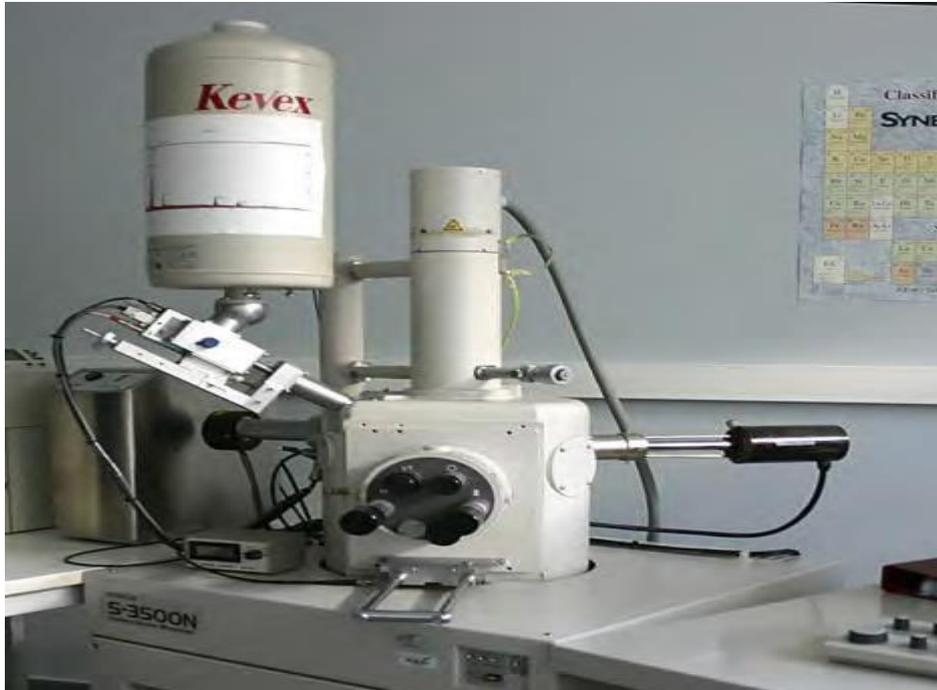
**Figure II.13: Microscope Electronique à Balayage (MEB), Hitachi S3500**
