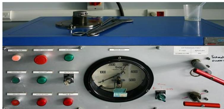
Figure II.7: Photo de la presse isostatique
