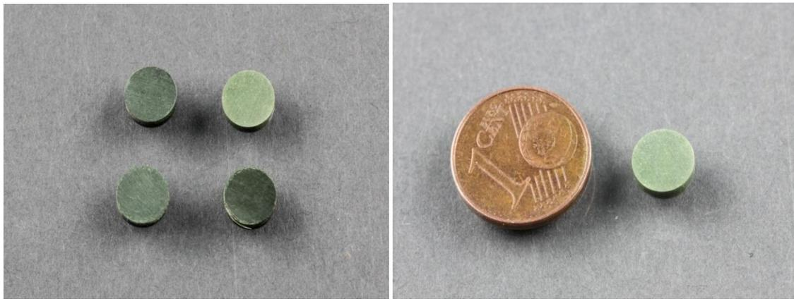
Figure III.15: Photo de quelques varistances réalisées par frittage conventionnel
