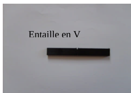
Figure II-9: Spécimen 40/10/4 entaillé pour test de résilience ; Charpy
