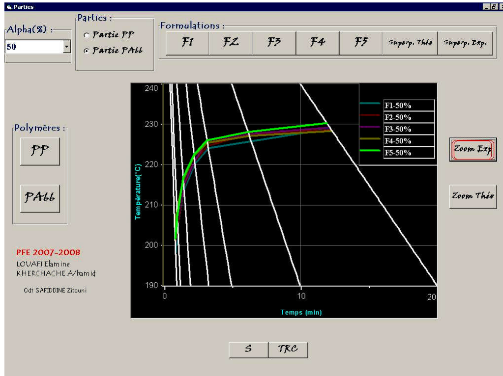
Figure IV-68 : Fenêtre de l'interface illustrant un zoom effectué sur la superposition des T.R.C expérimentales de la partie PA66 pour un taux de transformation de 50 %
