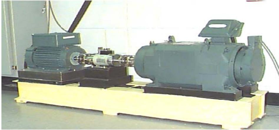
**Fig3.11-** Banc d'essai de roulements.
