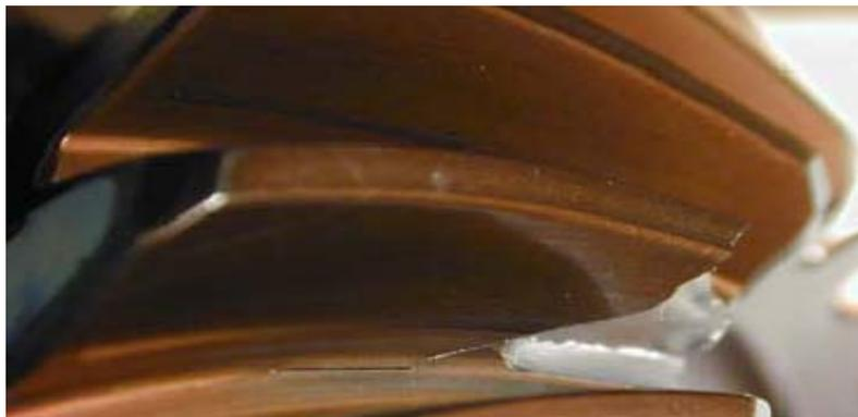
**Fig1.9-** Défaits de fracture.
