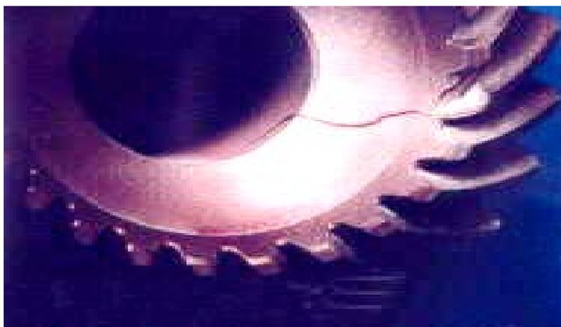
**Fig1.7-** Défaut de fissuration.
