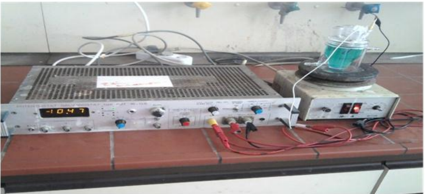
Figure (IV -1) : Dispositif expérimental du montage servant à la dégradation du colorant Bleu de méthylène.
