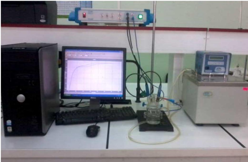
**Figure II.1:** Montage électrochimique à trois électrodes.
