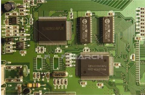
**Figure (III.27):** Carte électronique avec manque de composants [4].
