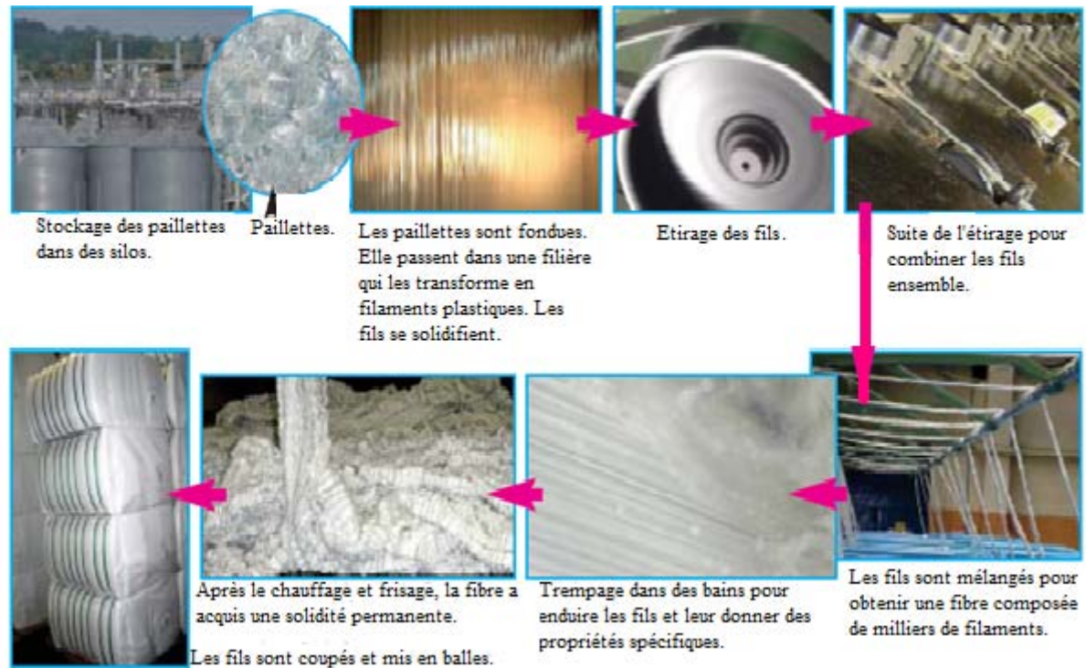
Figure II.8 Processus de fabrication des fibres en PET [70].
