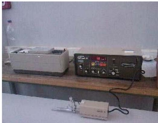
**Figure. 4 :** Rugosimètre « Mitutoyo SurfTest-4 ».
