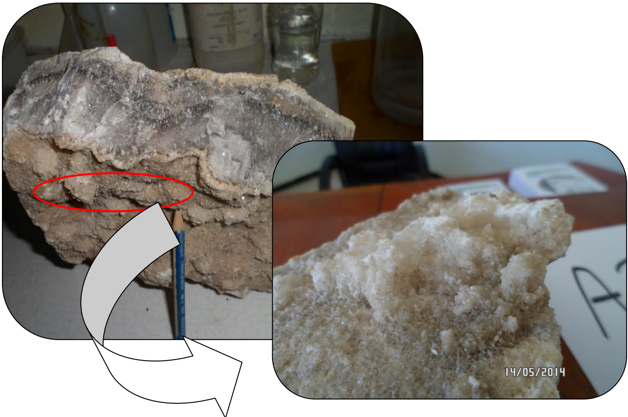
Photo III.3. Montre la structure botrydale des gypses couvrant les voutes des karsts
