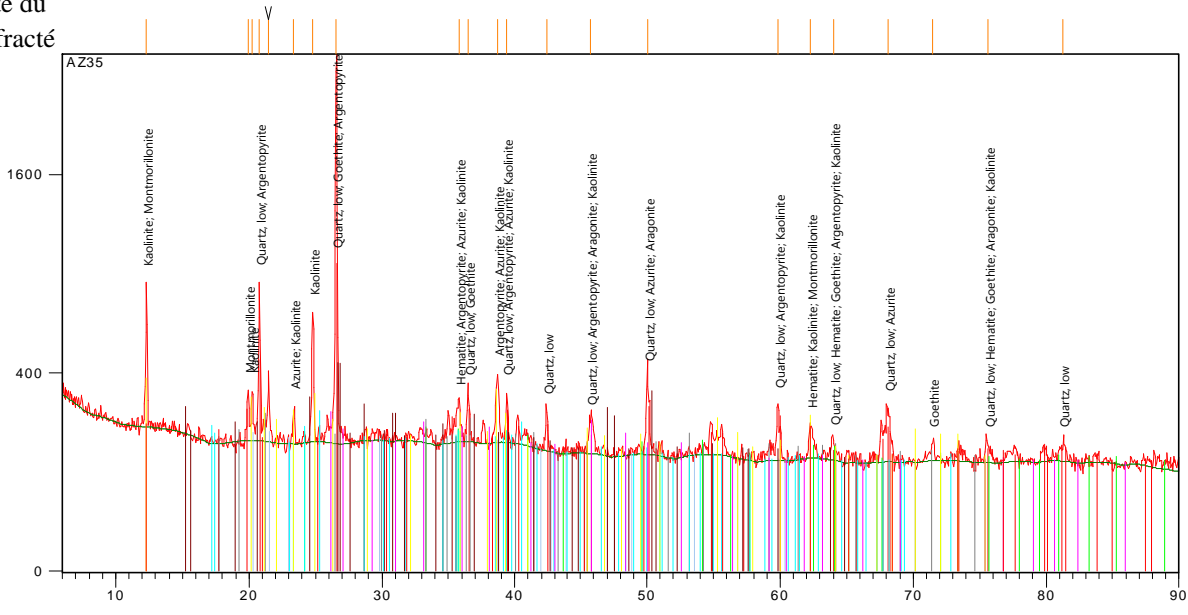
Fig.III.10. résultats des analyses minéralogiques par les rayons X pour AZK35
