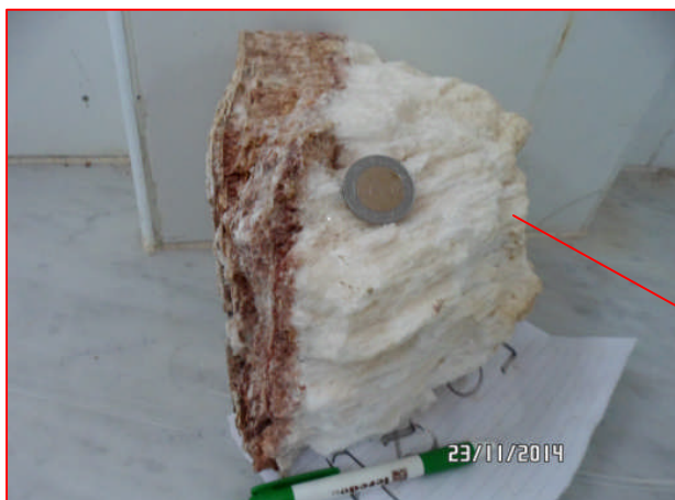
Photo III.11. Montre les amas de gypse en structure radiale (fibreuse) et botroydale couvrant le toit de la galerie
