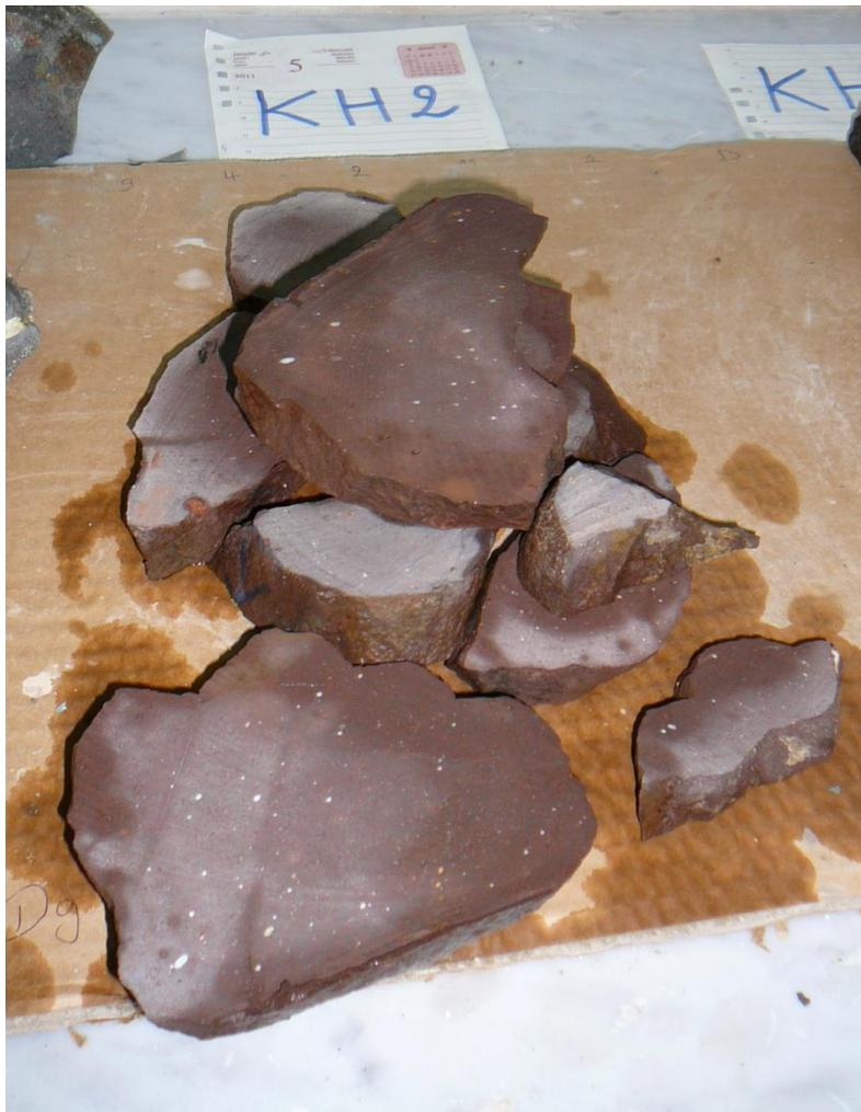
**Figure III.20 :** sections de KH2 montrant la couleur rougeâtre de l'échantillon et les vacuoles remplies de calcite (texture amygdalaire).
