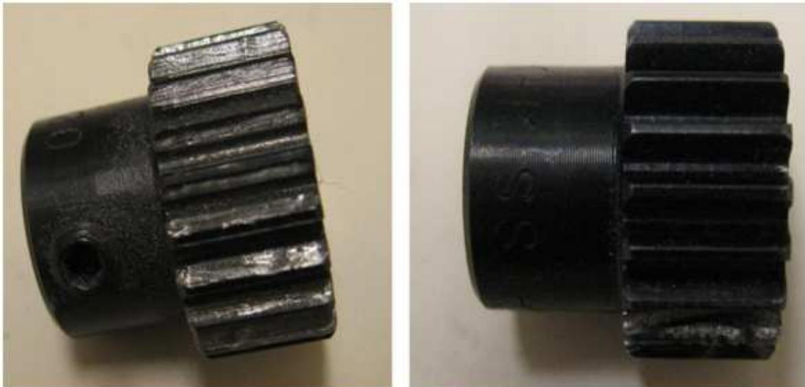
Fig. 1.11: Un défaut d'engrenage (à gauche : l'usure de toutes les dents ; à droite: fragment d'une dent) [Feng, 2014].
